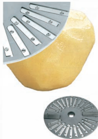
Schälsscheibe mit aufgesetzten Messern Glatte Oberfläche – wie handgeschält. Erhöhter Schälabfall, geringste Rötung, kürzere Schälzeit.
