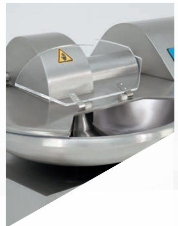
Cutterhaube mit transparentem Lärmschutzdeckel
