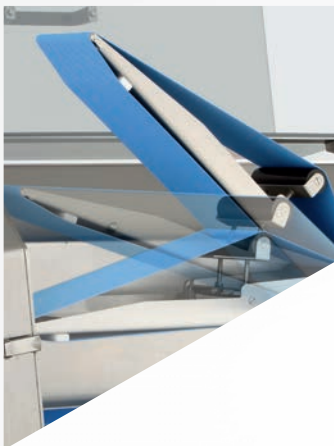
Produktgerechtes Einstellen des oberen Förderbandes
