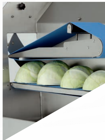
Dank der vorteilhaften Zuführbreite muss das Produkt nur grob vorzerkleinert werden
