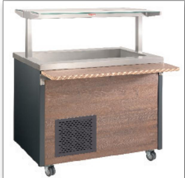
Kühlwanne für GastroNorm-Einsätze 3 oder 4 x 1/1-100. Kühlwanne aus CNS fugenlos in die Abdeckung eingeschweißt Aktive Umluftkühlung. Inkl. Lochblech. Steckerfertige Kältemaschine im Unterbau. Digitale Steuerung.
