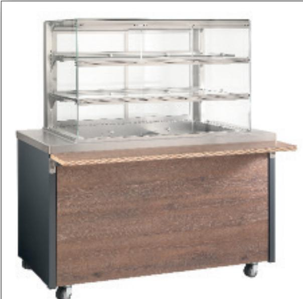
Umluftkühlvitrine aus CNS in die Abdeckung eingebaut. Mit Kühlwanne und 2 Zwischenborden. Zwischenbord und Einlegeboden schräg- und höhenverstellbar. Innenbeleuchtung (LED) je Etage. Gästeseitige Panoramaischeibe oder mit 9 Entnahmeklappen aus Acrylglas. Seitenscheiben und Zwischenborde aus ESG, bedien- seitige Schiebetüren aus Isolierglas. Steckerfertige Ausführung mit Tauwasserverdunstung, Tauwasserablauf HD 30. Digitale Steuerung.
